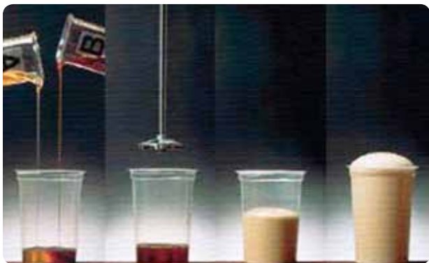
Bilde 13: Fire faser i ekspansjonen av stivt polyuretanskum (PUR/PIR) i et målebeger
